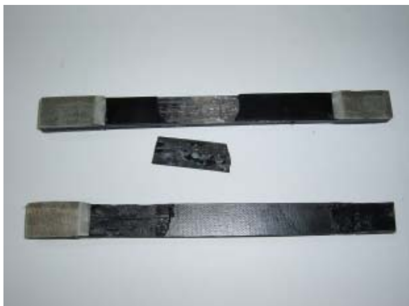
圖 5-43 接合的複材破壞試片
