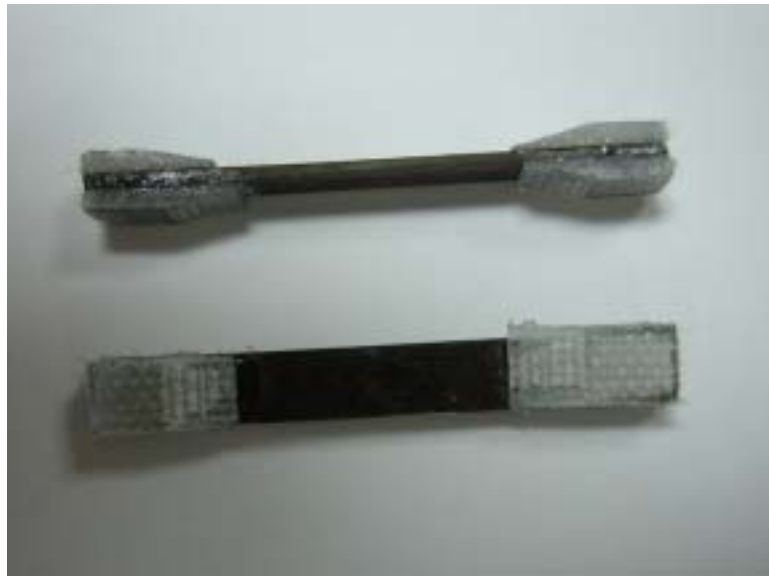
圖 5-7 CNT/phenolic 測試試片的外型 (1wt%)
