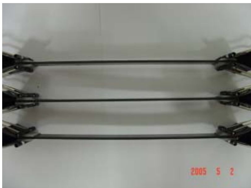
圖 5-37 Gr/epoxy 測試試片的外型
