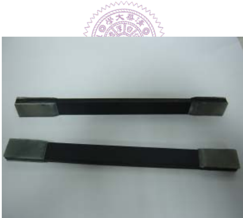
圖 5-37 Gr/epoxy 測試試片的外型
