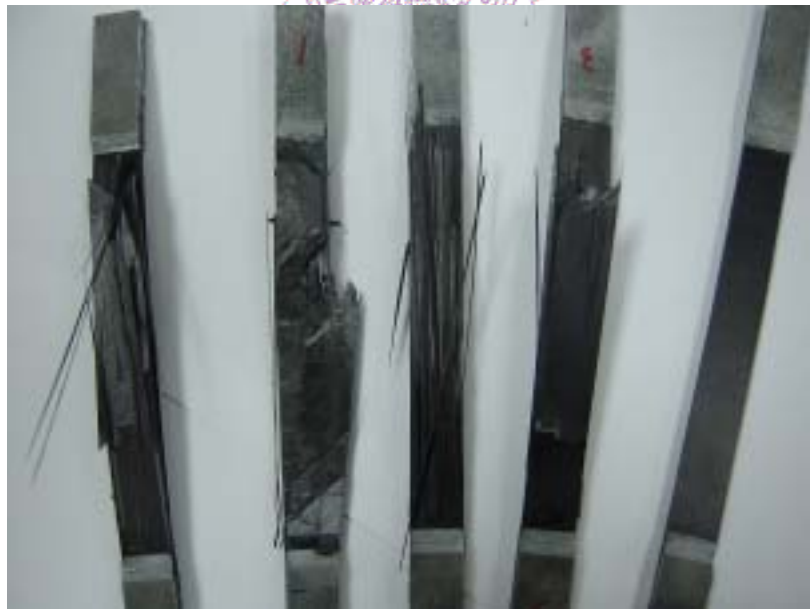
圖 5-40 Gr/epoxy 破壞斷面圖
